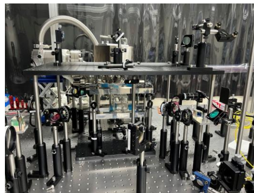
図1 開発中の二次元磁気光学トラップ装置の外観
